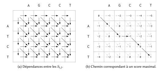
Fig. 2. Matrice des scores associée aux séquences AGCCT et ATCT en prenant pour paramètres  $\alpha = \beta = \delta = 1$ . Le chemin illustré dans la deuxième figure correspond à l'alignement AGCCT / AT\_CT.
