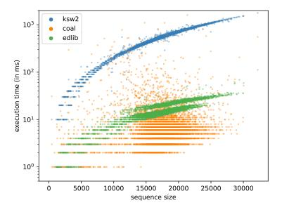
Fig. 6. Graphique en échelle logarithmique des temps d'exécution de coal, edlib et ksw2 sur le jeu de données fourni par PacBio.
